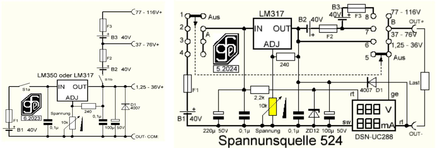
Diese Schaltung ist nicht ganz risikofrei, Beispiel: Eine Last ist an der Buchse 37-76V+ oder 77-116V+ angeschlossen, die Sicherung F1 löst bei Überlastung aus – dann würde der Stromkreis über OUT-COM – Pot 10k – 240 Ohm geschlossen und diese Bauteile je nach angeschlossener Last überlasten oder zerstören. Dies wird durch die Schutzdiode D1 verhindert.
