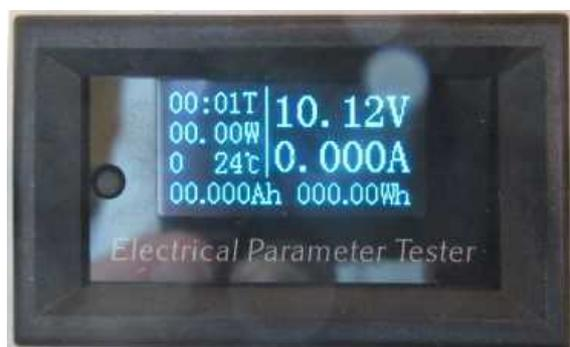
Der Dezimalpunkt der Spannungsanzeige muss um eine Stelle nach rechts versetzt werden, richtiger Wert ist 101,2V.
