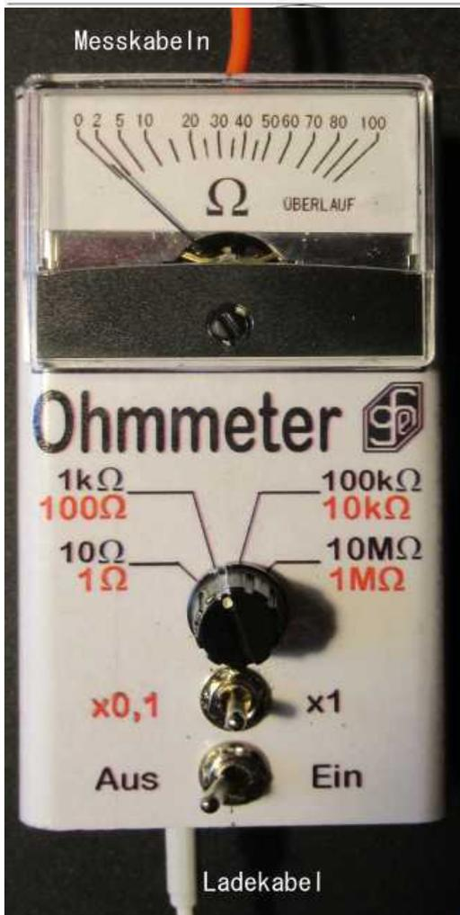
Das fertige Gerät mit den Gehäusemassen 125 x 70 x 40mm Halbschalengehäuse SD20 +SD10. Die beiden weissen LED's sind als Skalenbeleuchtung hinter der schwarzen Blende im Instrument verbaut. Beleuchtungsmöglichkeit schon vorgesehen. Die Überlauf LED wurde in die Skala integriert.
