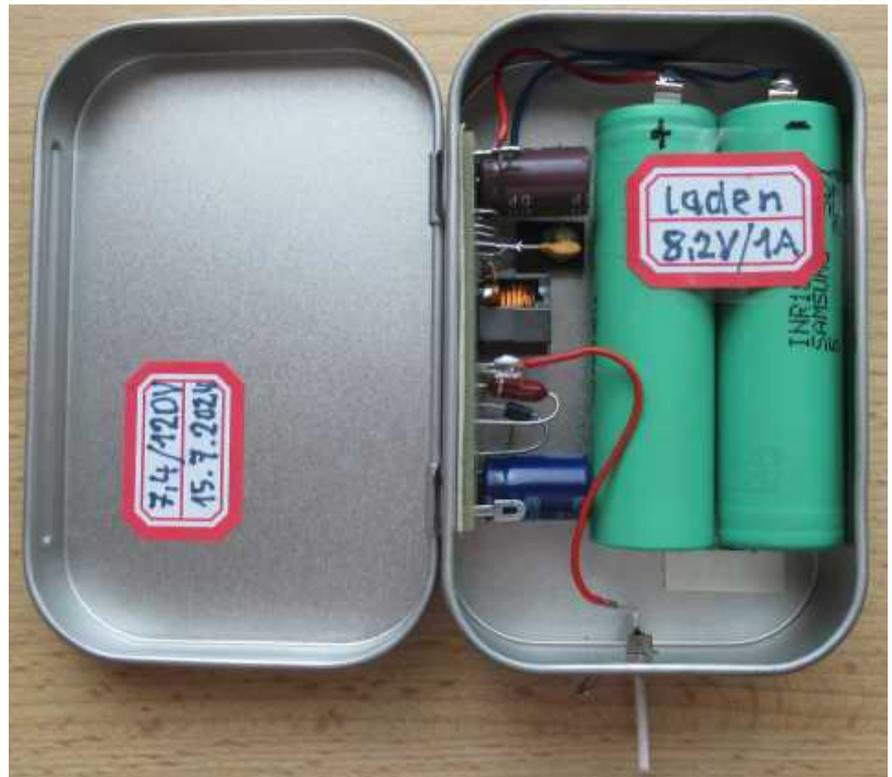
Der Spannungsausgang ist mit einem Isolierschlauch gegen Berührung und Kurzschluss gesichert
