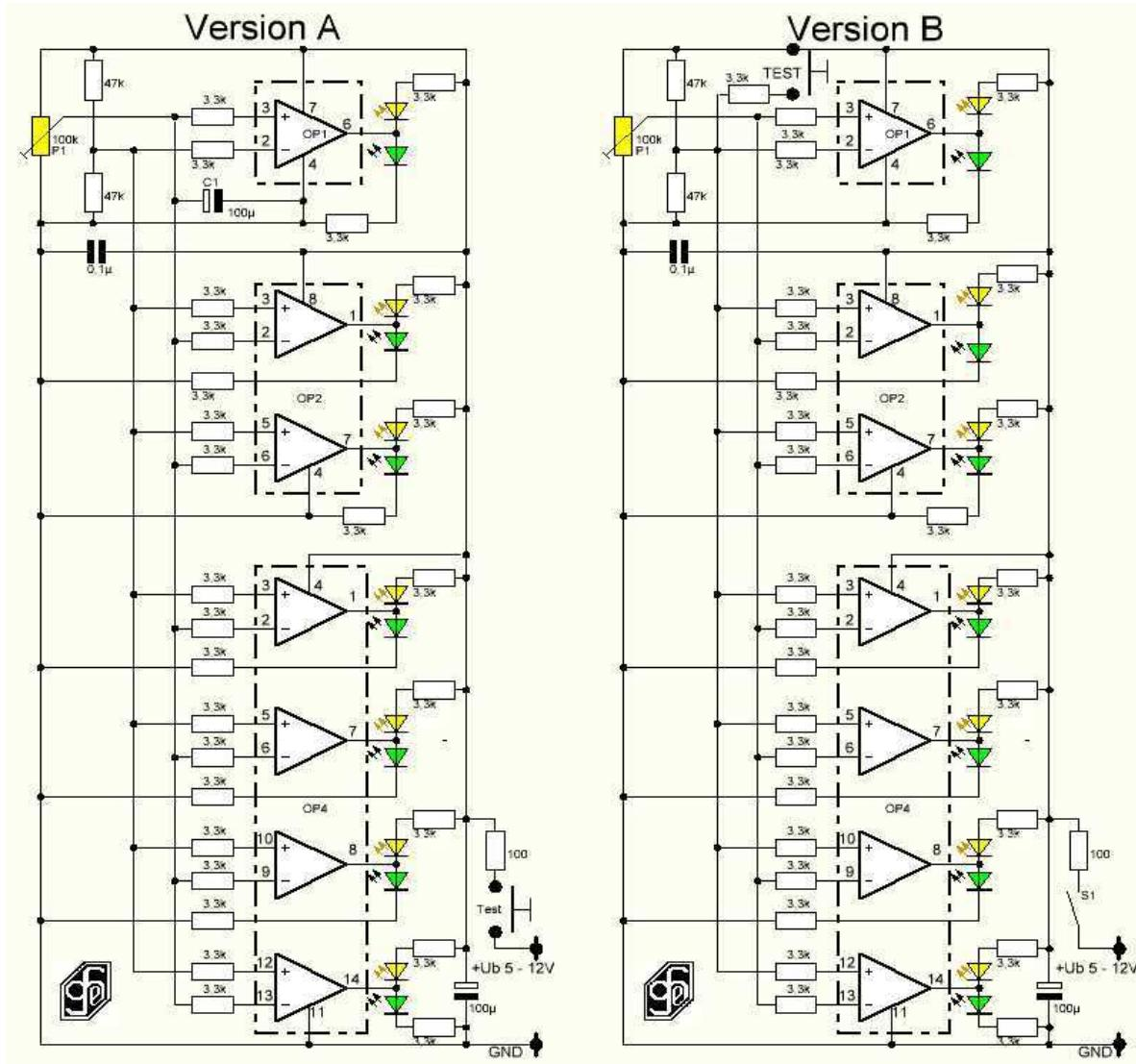
**Tester für Operationsverstärker (OPV).** 3 Testvarianten sind möglich:
