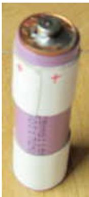
Am besten eignen sich alte Batterien mit Plastikhülle. Die Bördelung unten wird mit einem Messer abgetrennt damit die beiden 1,5V-Zellen nach unten heraus gedrückt werden können.
