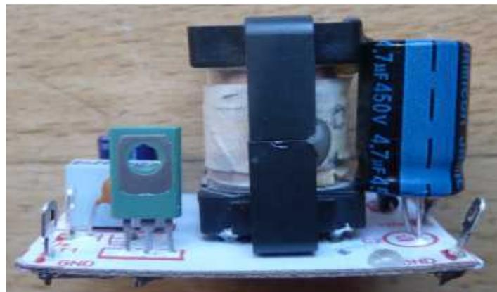
Printaufbau mit E-Kern „B“, Masse: 50 x 35 x 35mm
